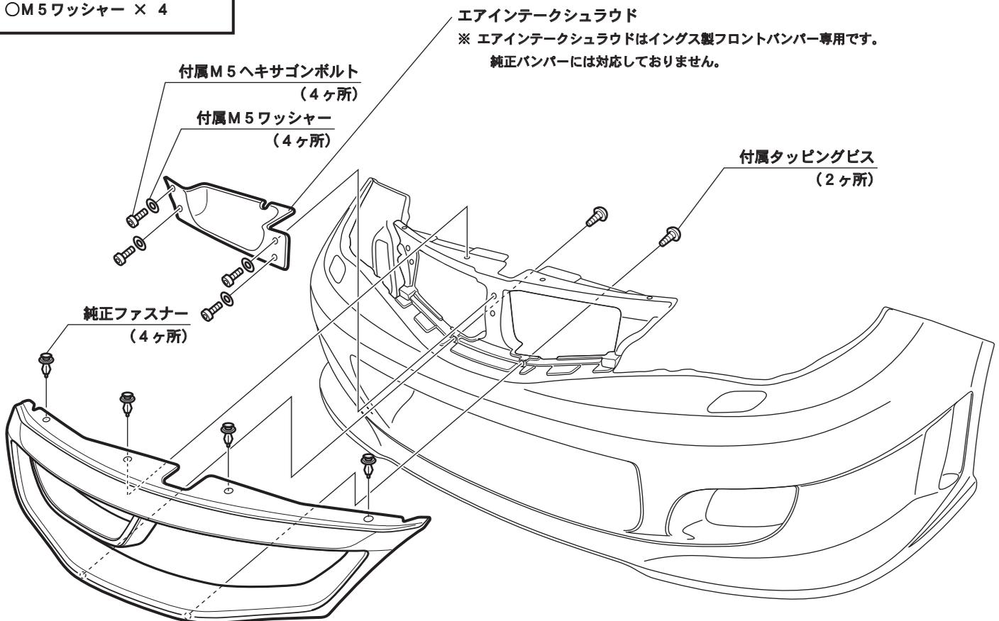
■ イラストはインクス製フロントバンパーですが、純正フロントバンパーの場合でも同様に取り付けてください。
